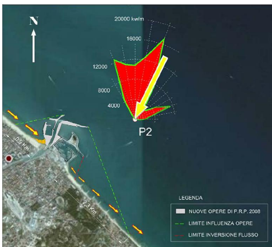
Figura 148 - Andamento delle componenti longitudinali dei vettori del flusso di energia in prossimità delle opere del porto di Pescara (da Relazione "Studio morfologico" Prof. De Girolamo).
