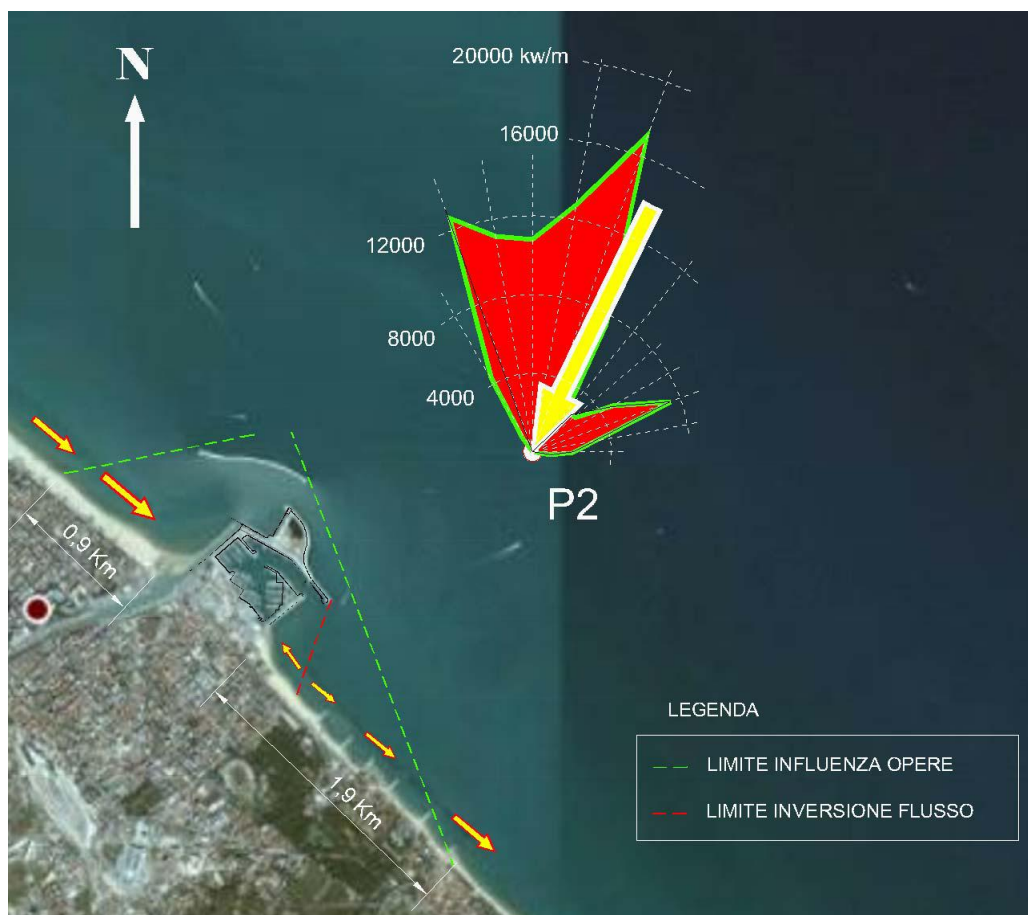
Figura 62 - Situazione attuale: andamento delle componenti longitudinali dei vettori del flusso di energia lungo la costa (da Relazione “ Studio morfologico ” Prof. De Girolamo).
