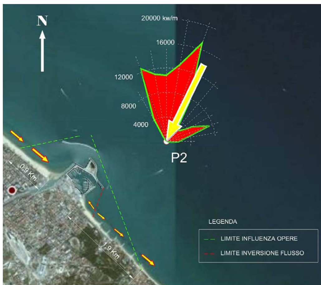
Figura 161 - Situazione attuale: andamento delle componenti longitudinali dei vettori del flusso di energia lungo la costa (da Relazione “Studio morfologico” Prof. De Girolamo).
