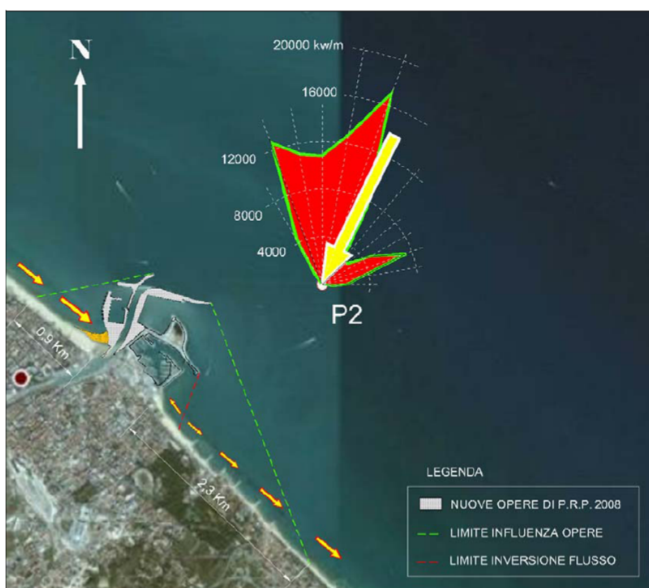
Figura 181 - Andamento delle componenti longitudinali dei vettori del flusso di energia in prossimità delle opere del porto di Pescara (da Relazione “Studio morfologico” Prof. De Girolamo).
