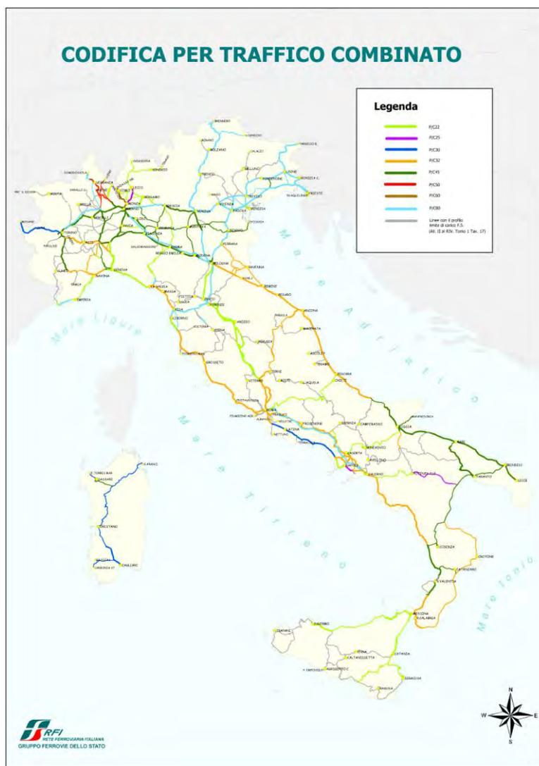
*Caratteristiche delle linee ferroviarie secondo codifica per traffico combinato. (Fonte: RFI 2010)*
